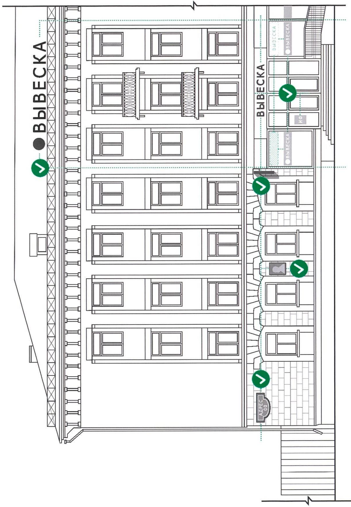
Иллюстрация 2. Рекомендуемые варианты размещения информационных конструкций различных видов на фасаде здания, строения, сооружения и ограждения.
