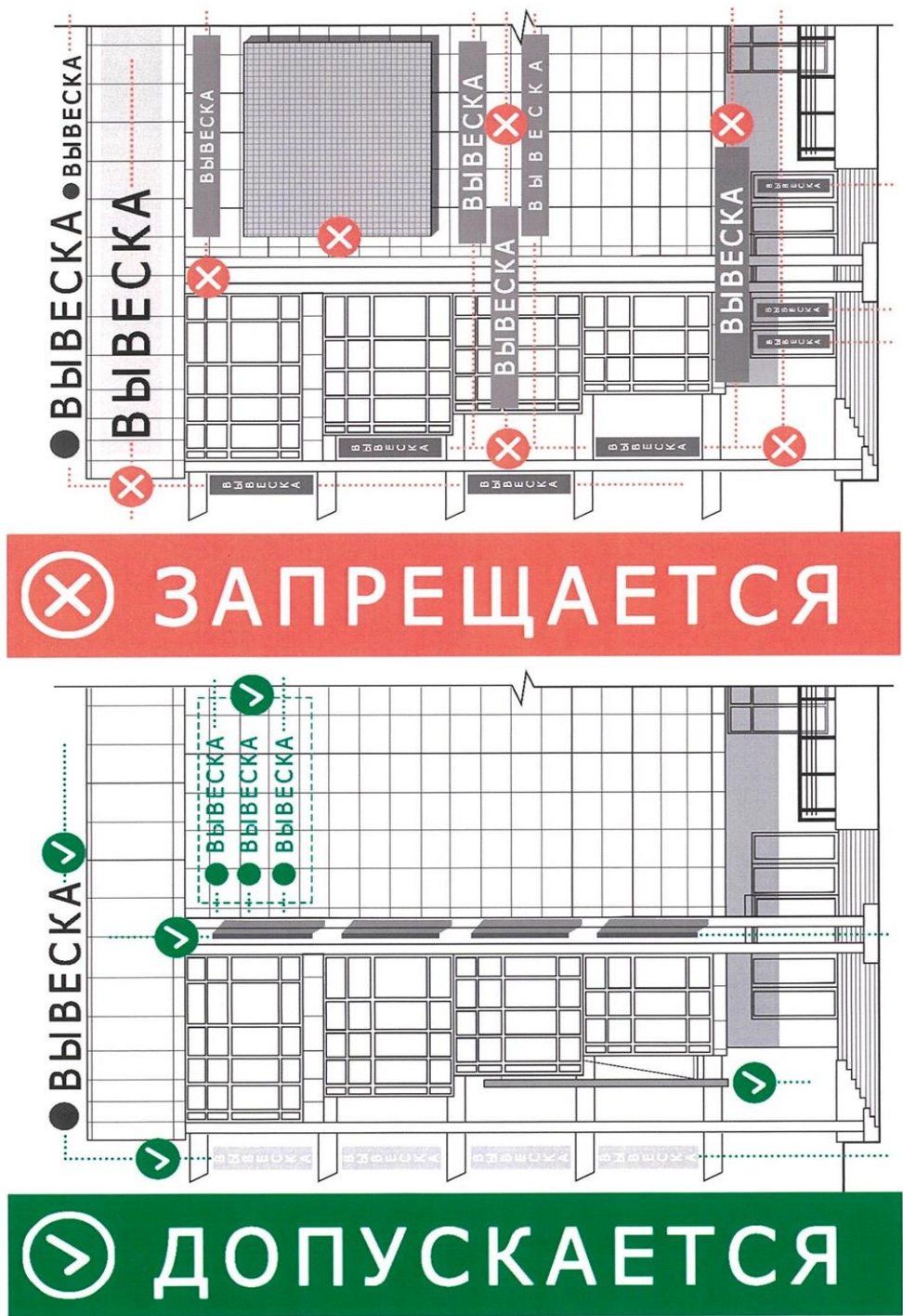
Рисунок 7. Вариант размещения информационных конструкций на фасадах торговых центров, торгово-развлекательных центров (комплексов) общей площадью свыше 5 тыс. кв. м, на спортивных и спортивно-зрелищных зданиях и сооружениях с числом мест для зрителей более 500.
